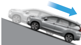
بدون نظام التحكم المساعد للإقلاع على المرتفعات Without Hill Start Assist
